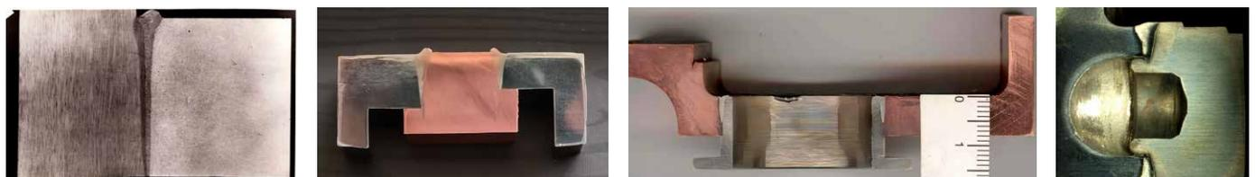
**Bild 6:** „Schwarz-Weiß“-Verbindung (links), hochlegierter Chrom-Nickel-Stahl mit Kupfer (links Mitte), CuCrZr mit Ni (rechts Mitte), „Inconel“ mit Vergütungsstahl (rechts) (© Schulze-Consulting)
